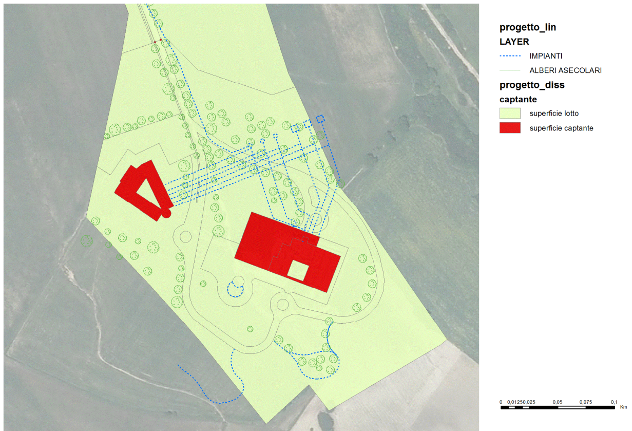
Figura 4 superfici di captazione acque meteoriche con cisterne
